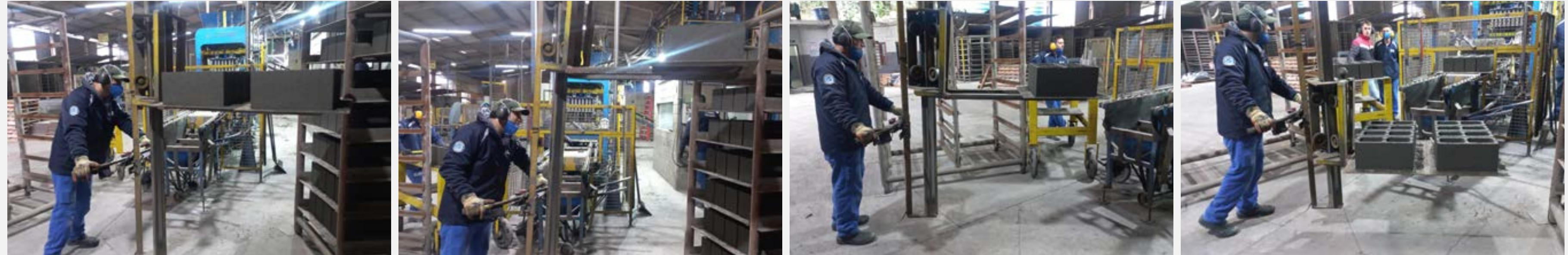
O projeto “Pinça de Desforma”, implementado em 2022, surgiu para garantir mais segurança e eficiência na desforma de blocos e pavers, antes feita manualmente, com alto esforço físico, rotatividade, faltas e afastamentos
